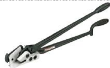
型号: CU-25 产品编号: 005740 可用于移除捆带或者预剪定长捆带 切刀为双刃,并且可以更换 适用50.8×1.27mm以下规格捆带 重量: 3.6kg(8磅)
