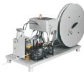
DPCL 内自动剪断定长100英尺(30.48米)以下钢带
