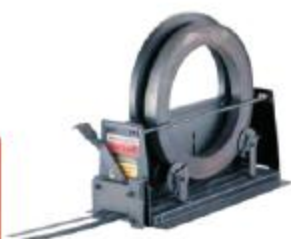
DC-1A 内置预剪切刀。可以放置两卷任何规格的单卷钢带。
