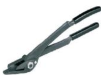
型号: CU-30 产品编号: 005899 轻量型,单手操作即可 采用优质改良合金钢制造 适用31.8×0.89mm以下规格捆带 重量: 1.35kg(3磅)
